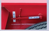
Válvula de control de altura de carrocería mecánica fácil de alcanzar para ajustes rápidos y fáciles.
